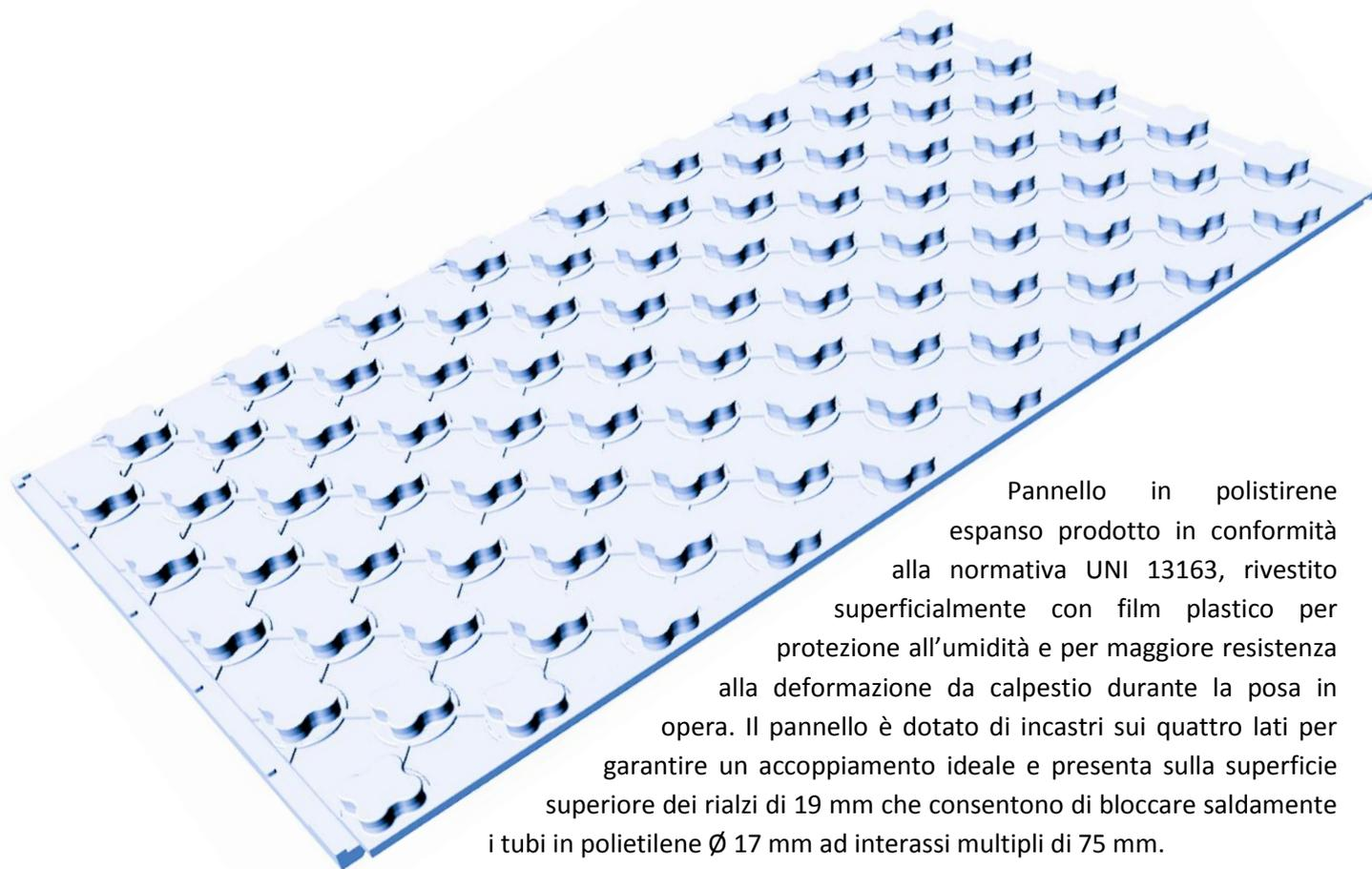
Pannello in polistirene espanso prodotto in conformità alla normativa UNI 13163, rivestito superficialmente con film plastico per protezione all'umidità e per maggiore resistenza alla deformazione da calpestio durante la posa in opera. Il pannello è dotato di incastri sui quattro lati per garantire un accoppiamento ideale e presenta sulla superficie superiore dei rialzi di 19 mm che consentono di bloccare saldamente i tubi in polietilene  $\varnothing$  17 mm ad interassi multipli di 75 mm.
